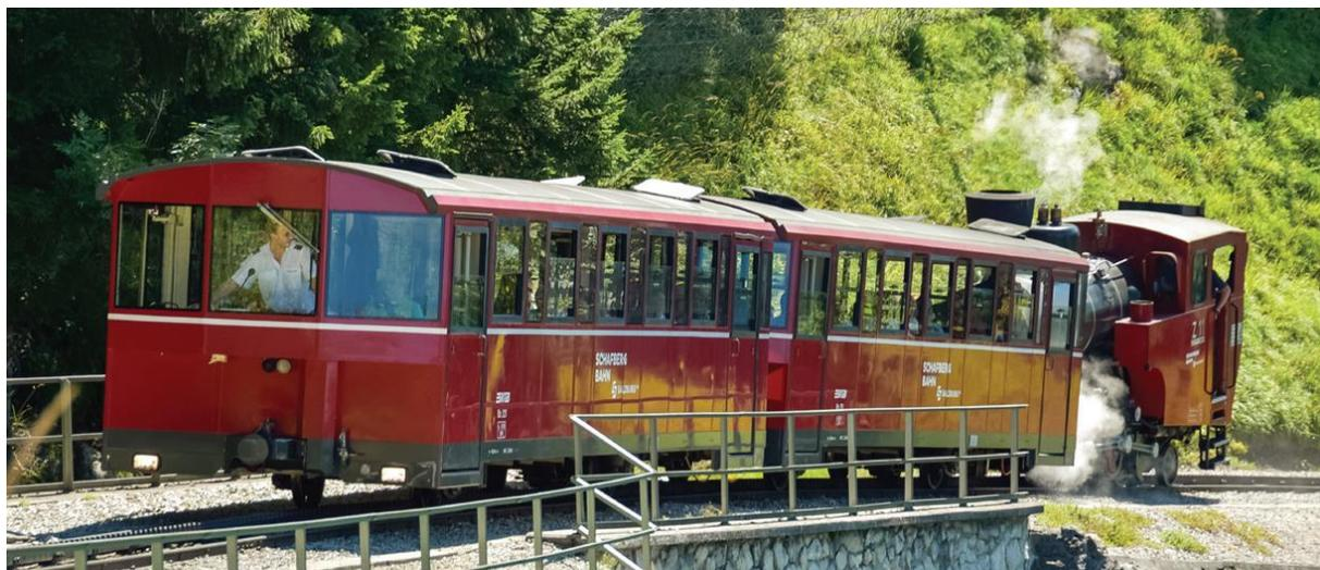
Im Zusammenhang mit der Dampflokomotivneubeschaffung Z11 kam es 1992 zur Bestellung von zwei Vorstellwagen aus Vollaluminium bei Bombardier Wien für die Schafbergbahn.
